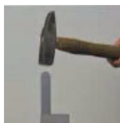
10-15 mm tief bis zum Klemmpunkt einschlagen
