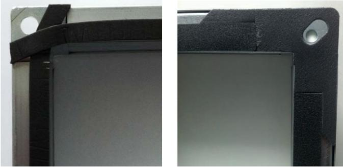
**An den Flanschecken sollte die Superdichtecke zum Einsatz kommen.**
