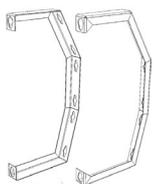
Die Konsole ermöglicht die Befestigung des Luftheizers an der Wand in 3 verschiedenen Winkeln: **0 °, 15 °, 30 °**
