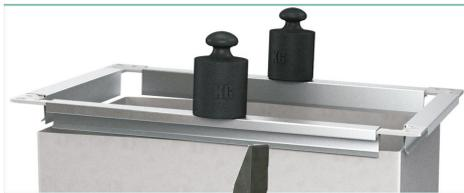
Die Rahmen sind nach dem Kürzen der Luftleitung aufzustecken und zu befestigen. Hierfür eignen sich druckdichte Nieten bzw. Selbstbohrschrauben. Das Nietbild ergibt sich aus dem Bild der Druckfügepunkte/Punktschweißpunkte am befestigten Flansch.
